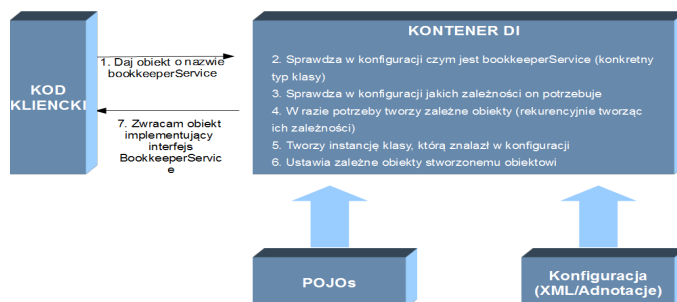
Rysunek 3. Zasada działania wstrzykiwania zależności
